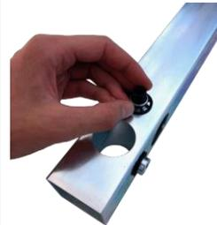
Bestücken Sie alle Muttern der Rohrhalter/Achsen mit den schwarzen Madenschrauben.
